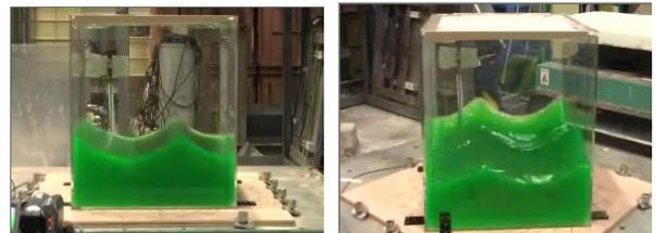
(a) 加振方向角 0° (b) 加振方向角 45°
