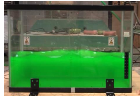
写真-5 短辺方向2次モードの長辺方向の液面挙動（加振から20秒後）
